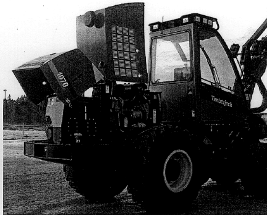
Sämtliche Hauben und Abdeckungen lassen sich leicht öffnen und ermöglichen einen schnellen Wartungszugang.
